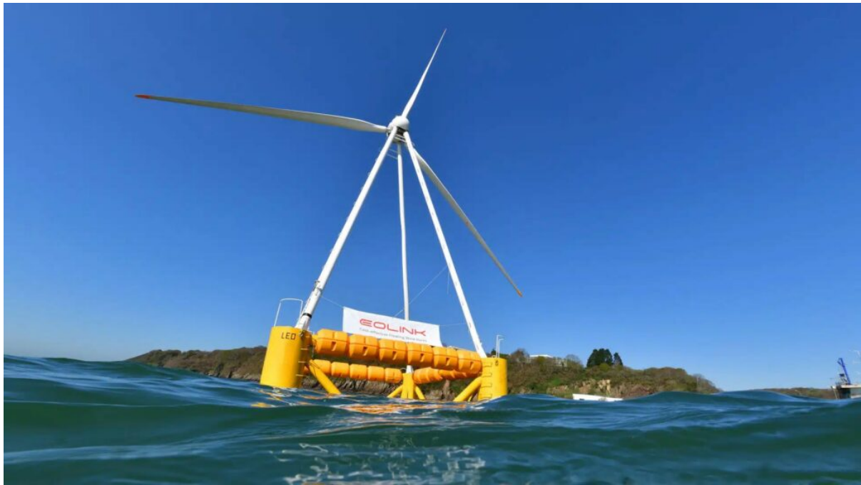
Un prototype d'éolienne flottante en phase de test. Photo : Ifremer-Eolink – O. Dugornay
